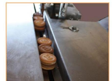
این سیستم بر روی دستگاه های پیلوپک نصب می شود که می توان جهت بسته بندی بیسکوئیت به صورت چند عددی از آن استفاده نمود.
