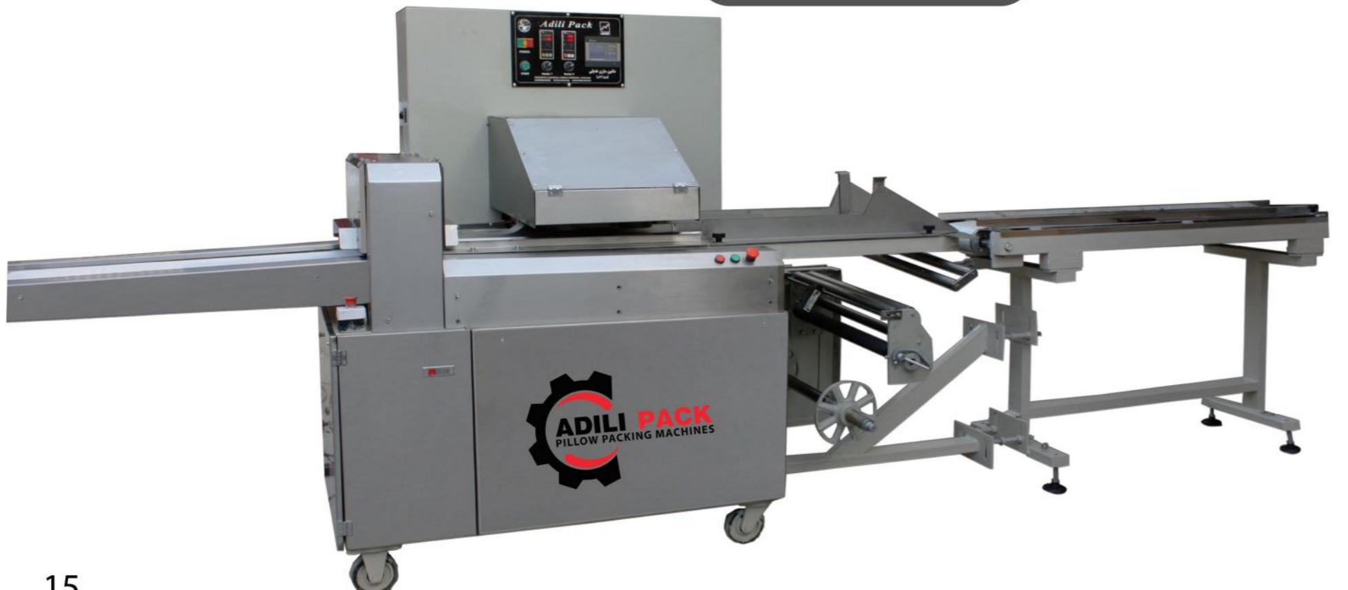
دستگاه بسته بندی به صورت دوخت از بالا، مناسب بسته بندی محصولات به صورت تک عددی یا چند عددی می باشد؛ به طور مثال بسته بندی محصولاتی مانند: نان باگت چندتایی، پک قاشق و چنگال، دستکش کار، قطعات صنعتی و برقی، اپلیکاتور(به صورت بسته های هفت عددی)، و... انجام پذیر است.
